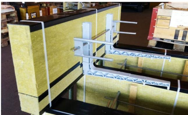
Elemente mit Abschälwinkeln und abnehmbarer Dämmaufdopplung
