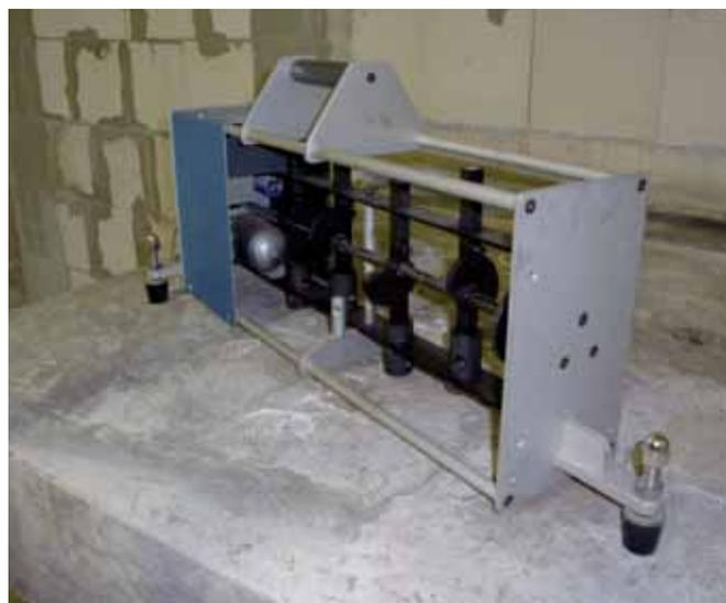
Normhammerwerk nach DIN EN ISO 10140
