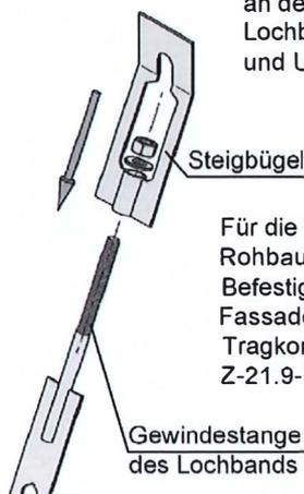
Für die Montage des Rohbauteils, sowie die Befestigung der Fassadeplatte an der Tragkonstruktion gilt Z-21.9-1910, Anlage 12
