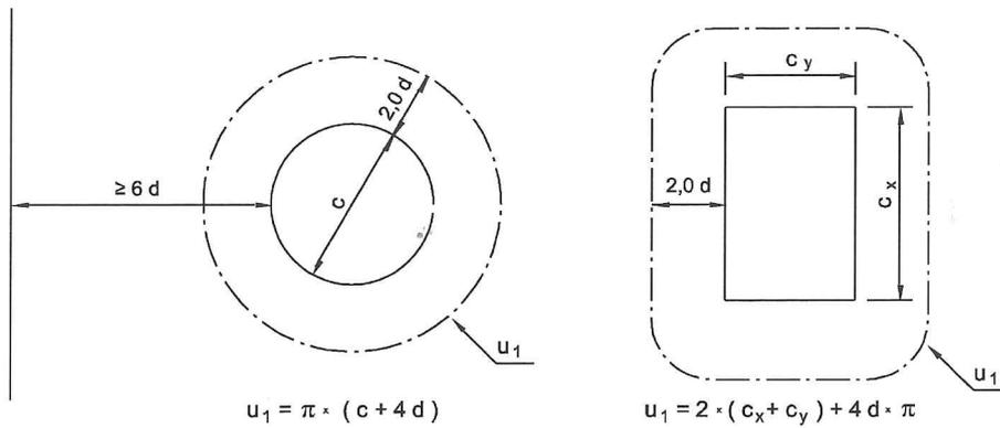
b) Belastete Fläche (Stütze) liegt weniger als  $6d$  von Plattenöffnungen (Aussparungen) entfernt
