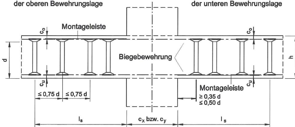
Betondeckung  $c_o$  bzw.  $c_u$  nach EN1992-1-1 : 2004 + AC : 2010, Abschnitt 4.4
