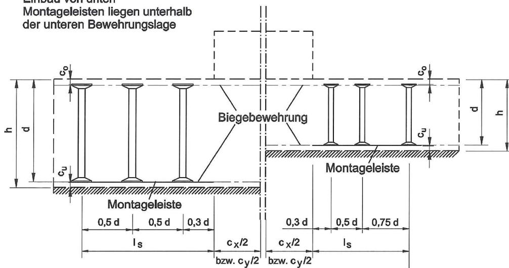
Betondeckung  $c_o$  bzw.  $c_u$  nach EN1992-1-1 : 2004 + AC : 2010, Abschnitt 4.4
