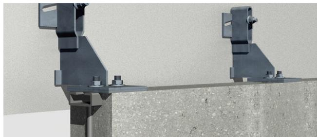
Suspension d'éléments en béton aux consoles au moyen de rails, de tiges filetées ou de douilles. Le linteau en béton doit être suffisamment armé pour supporter la maçonnerie.
