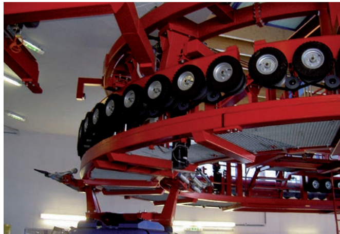
Fixation de l'unité motrice d'une remontée mécanique
