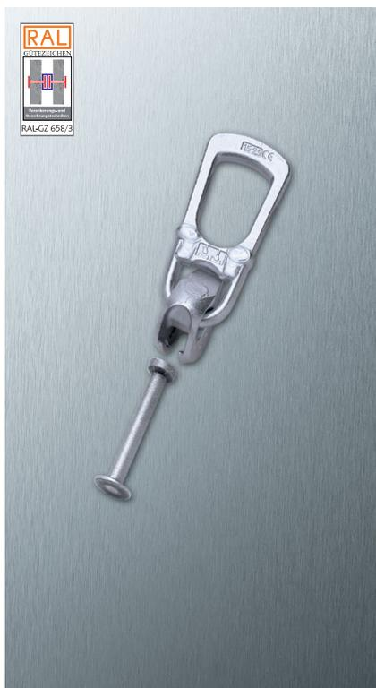
L'ancre de levage à tête hémisphérique HALFEN DEHA est bétonnée avec un corps d'évidement. Ce dernière est retiré après bétonnage. Le coupleur universel est accroché rapidement dans l'ancre. L'élément peut être levé et transporté.
