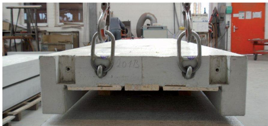
La douille de levage HD avec protection de douille et support de données intégré couvre la plage jusqu'à 25 t avec seulement neuf classes de charge. La douille de l'ancre peut être commandé en acier inoxydable. Le système de protection de douille demeure dans la douille pendant toutes les étapes de travail et offre une protection continue contre les salissures en tout genre.
