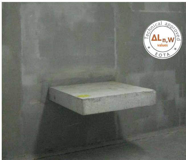
Banc d'essai conforme à DIN EN ISO 10140 avec élément intégré
