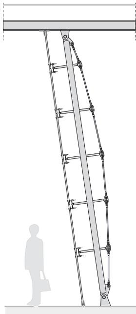
Le système Halfen Detan permet de réaliser des structures de support minimalistes pour les façades en verre.
