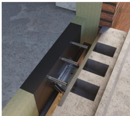
Dans le cas d'une fixation du côté du balcon, des évidements sont prévus dans le balcon pour permettre la liaison par l'extérieur du bâtiment.
