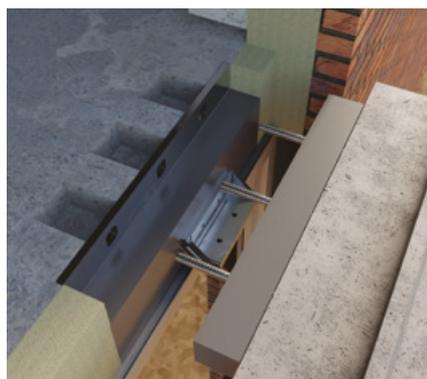
Dans le cas d'une fixation du côté de la dalle de structure, des évidements seront prévus du côté de la dalle intérieure.
