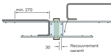
La grande distance d'au moins 270 mm entre les barres transversales facilite l'insertion des crochets aux extrémités de l'armature de traction.
