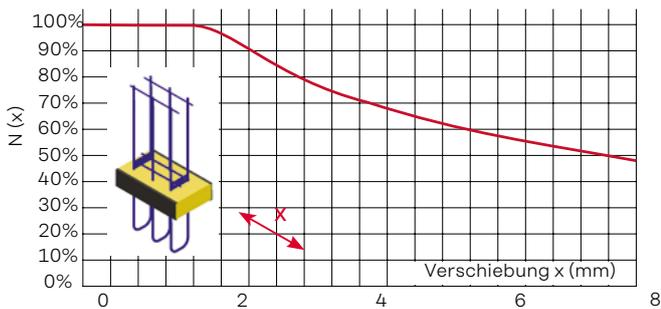
Réduction lors de déplacement en raison de retrait ou de modification longitudinale liée à la température. Le déplacement attendu doit être défini par le concepteur.
