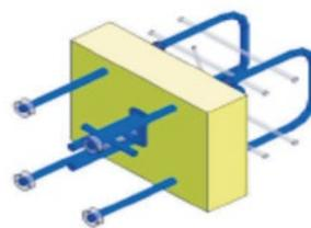
Avec barres de raccordement et ancrages terminaux raccourcis (console en 2<sup>ème</sup> étape).
