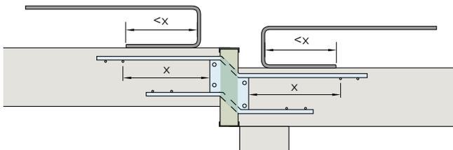
La distance entre les barres transversales et l'isolation est spécifiée pour chaque type. La branche terminale (X) du crochet doit être 30 mm plus courte.
