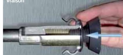
Vissage de la fixation. Le système de protection HSS descend en même temps dans le filetage. Positionner le clip d'identification dans le sens souhaité (en fonction de la position de l'armature de basculement).
