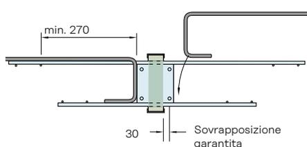
La grande distanza di almeno 270 mm tra le barre trasversali facilita l'inserimento dei ganci terminali del rinforzo di trazione.
