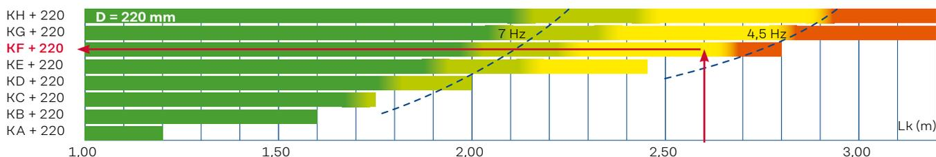
**Occorre selezionare il relativo diagramma in base all'altezza di collegamento del connettore per balconi.**
