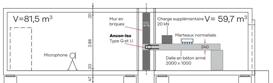
Insieme di prova delle misurazioni del suono da impatto nel laboratorio EMPA.
