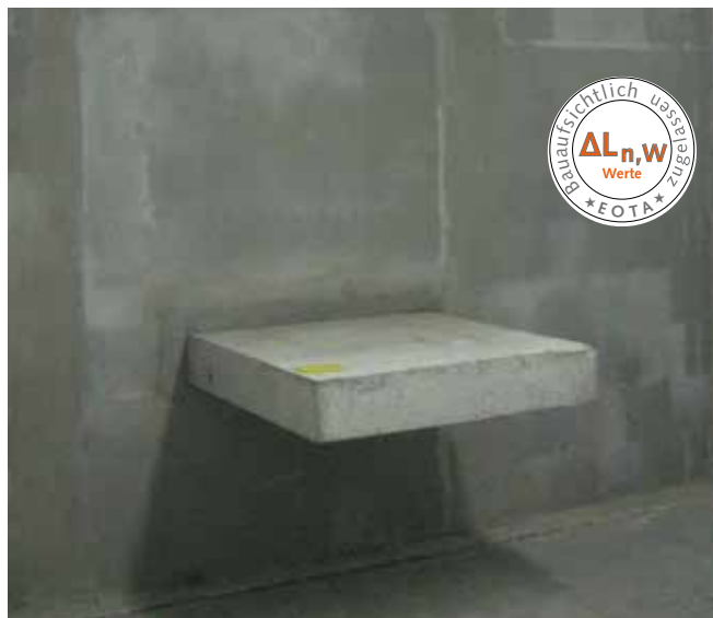
Proefopstelling volgens DIN EN ISO 10140 met ingebouwd element
