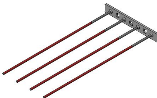
Fig.16: Trekstavenplaat met trekstaven
