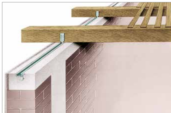
Bevestiging van houten balken met HNA spijkerankers aan ingestorte Halfenrail
